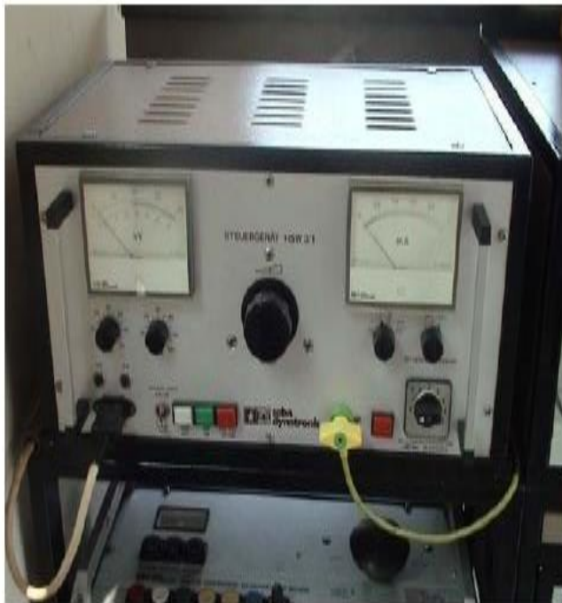
Tester Tegangan Tinggi Arus Searah Tester 20 kV Untuk memeriksa adanya tegangan pada kabel masuk / keluar kubikel
